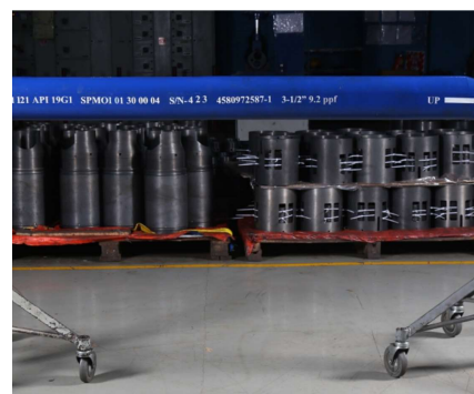
MANDRILES DE GAS LIFT EN PROCESO
