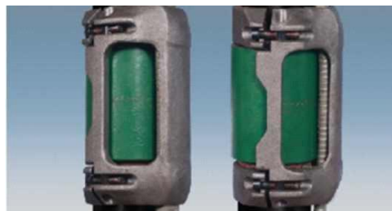
PROTECTORES INSTALADOS SOBRE EL ACOPLE
